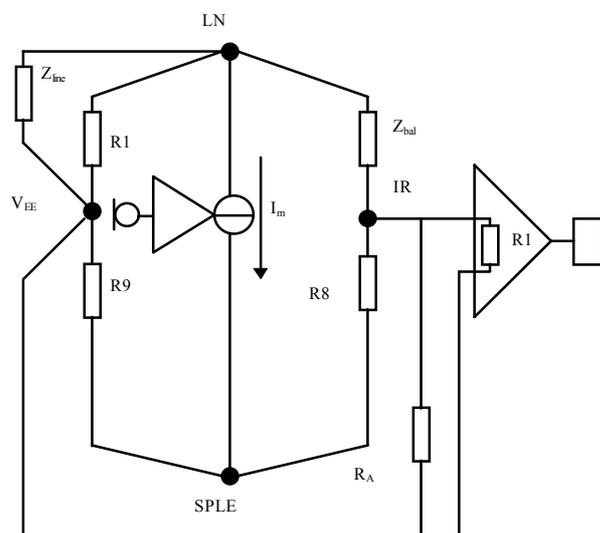
**Рисунок 5** - Эквивалентная противозоховая схема с использованием моста Витстона
