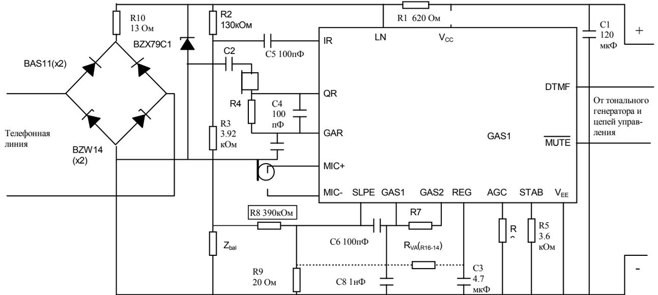
**Рисунок 14** - Типовая схема применения ILA1062AN с пьезоэлектрическим громкоговорителем.
