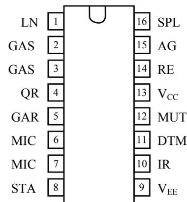
Рисунок 2. Назначение выводов корпуса
