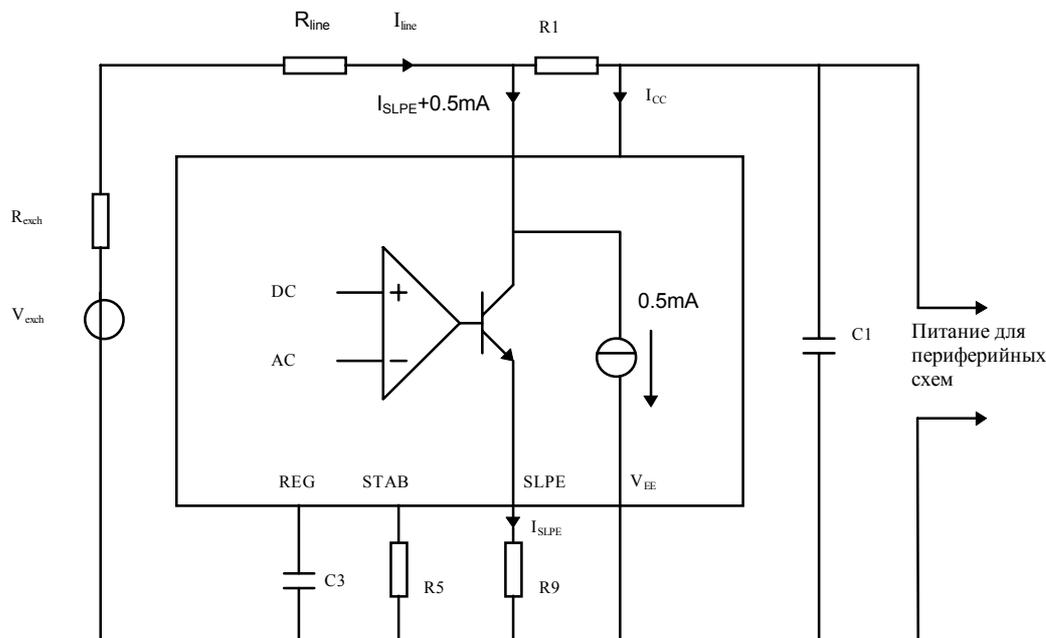
Рисунок 7 - Эквивалентная схема по напряжению питания периферийных схем.
