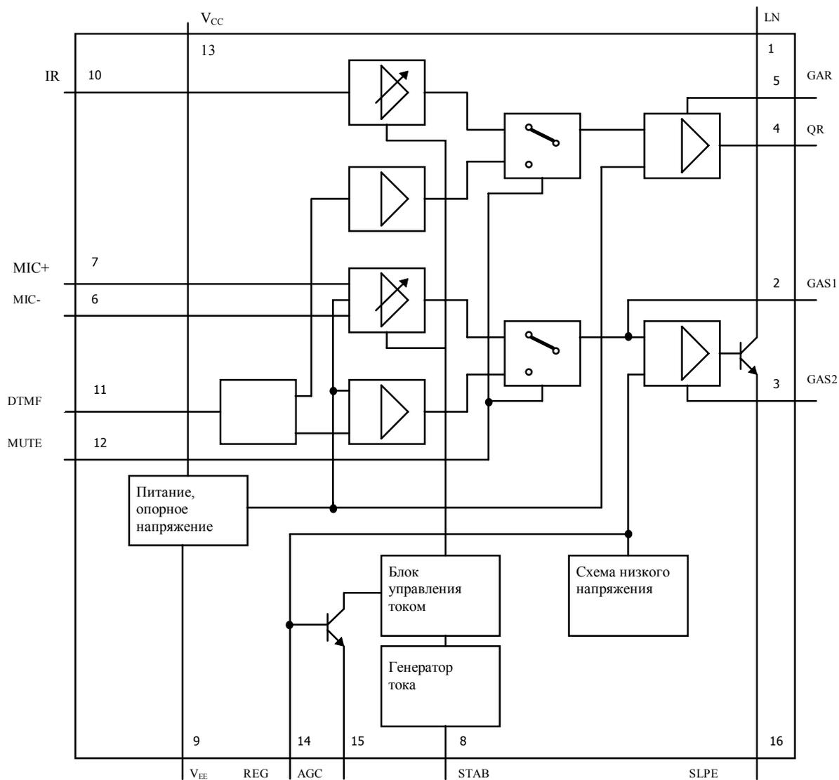
Рисунок 1 - Структурная схема микросхемы ILA1062AN
