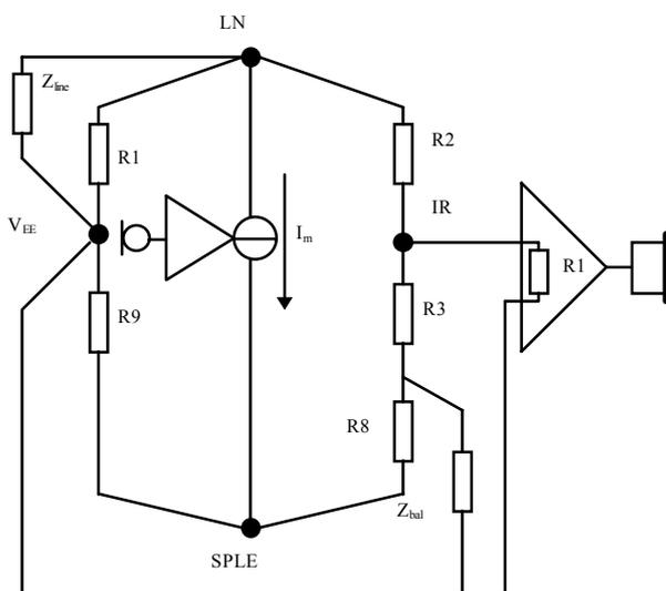
**Рисунок 4** - Эквивалентная схема противозохового моста серии ILA1062AN
