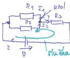
$$\sum_d U_d = 0 \quad i \text{ vyplýva z Maxwellovej rovnice } \operatorname{rot} \vec{E} = 0$$
