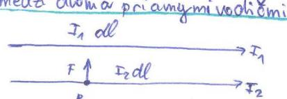
$$d\bar{F} = \bar{I} \cdot d\bar{l} \times \bar{B} \quad \text{Ampérov zákon - sila na kôlčie s prúdom v mag. poli.}$$
