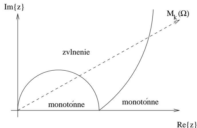
Obr.2.16 Oblasti monotónnej a zvlnenej magnitúdovej frekvenčnej charakteristiky v z rovine
