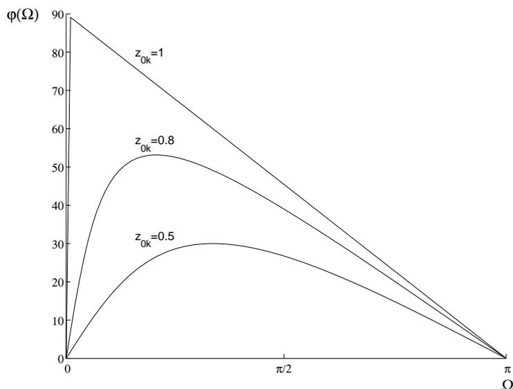
Obr.2.15 Priebeh  $\varphi(\Omega)$  fázovej charakteristiky pre rôzne  $z_{0k}$
