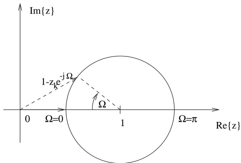
Obr.2.13 Zobrazenie vektora  $H(\Omega)$  v  $z$  rovine
