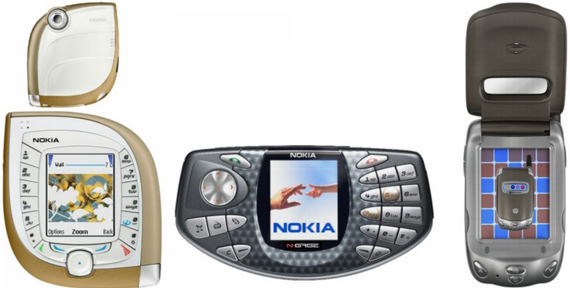
Obr. 13 (zľava) terminál s klávesmi po bokoch displeja; terminál určený na hry; terminál typu PDA s krytom displeja (na obrázku je zmenšený )
