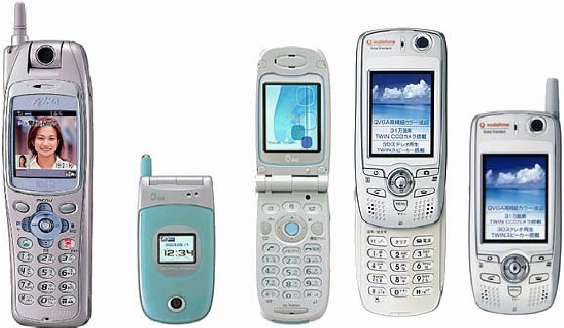
Obr. 12 (zľava) terminál „klasického vzhľadu“; roztvárací terminál – „véčko“; terminál so skrytou klávesnicou
