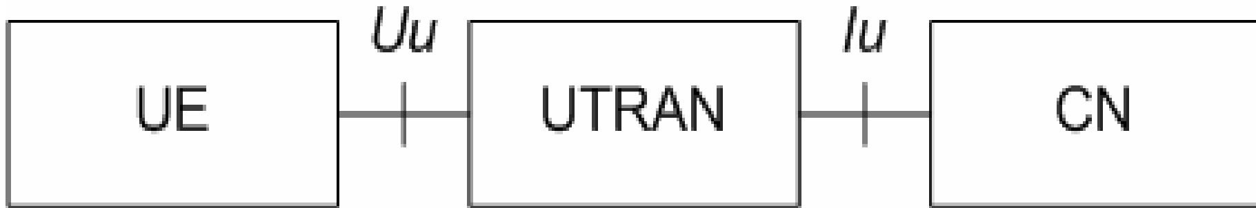
Obr. 6 Základná bloková štruktúra UMTS so štandardizovanými rozhraniami
